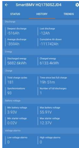
La aplicación VictronConnect mostrando el historial de un monitor de baterías BMW
